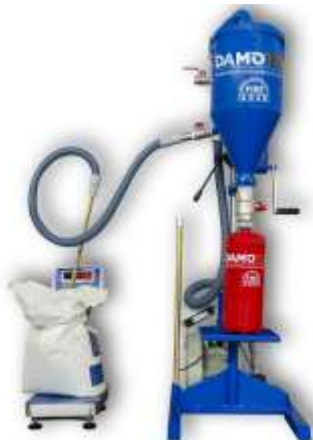
RIEMPIMENTO DI ESTINTORE PORTATILE
