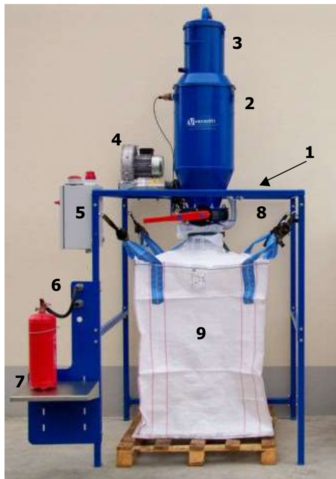
Récupération d'un extincteur à pression permanent
