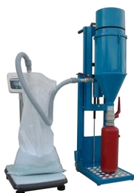
RIEMPIMENTO DI ESTINTORE PORTATILE
