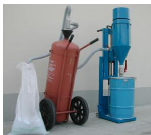
RIEMPIMENTO DI ESTINTORE CARRELLATO CON KIT "VENTURI"
