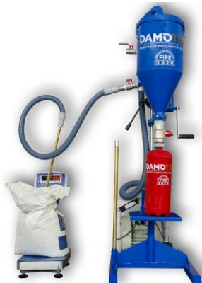
RIEMPLISSAGE D'EXTINCTEUR PORTABLE
