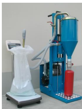
REMPLISSAGE D'EXTINCTEUR PORTABLE AVEC BALANCE ETW100
