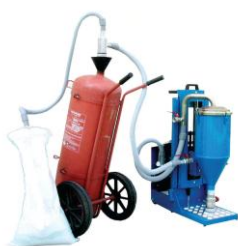
REMPLISSAGE D'EXTINCTEUR SUR ROUES AVEC KIT "VENTURI"
