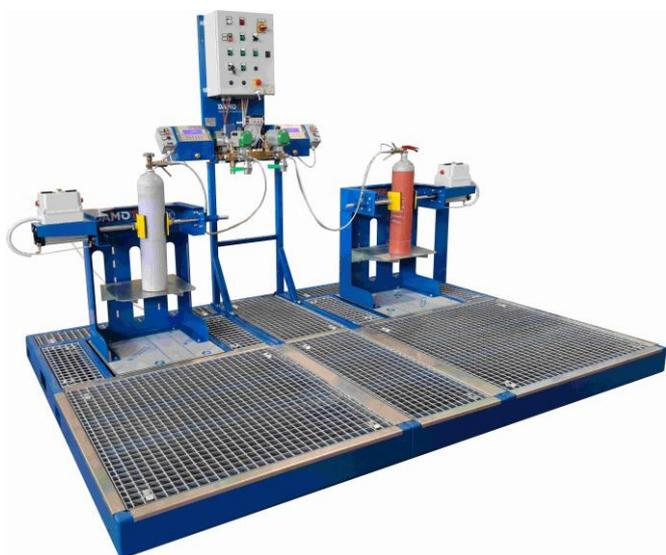
L'appareil FCD222 permet l'exécution du remplissage automatique de bouteilles et d'extincteurs CO<sub>2</sub> à partir d'un réservoir cryogène basse pression.
