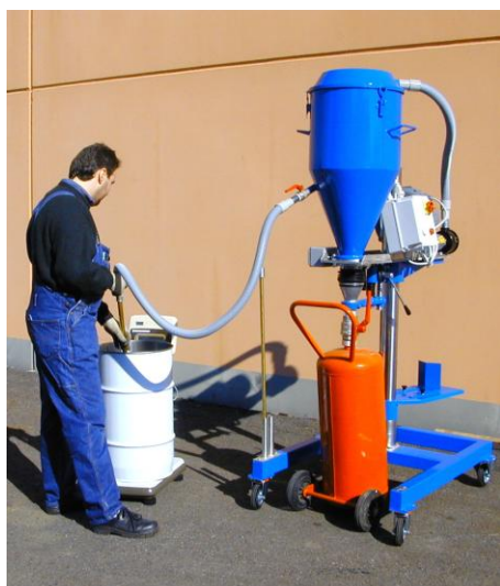
RECHARGE D'UN EXTINCTEUR SUR CHARIOT
