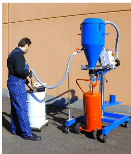
RIEMPIMENTO DI ESTINTORE CARRELLATO
