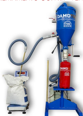
RIEMPIMENTO DI ESTINTORE PORTATILE
